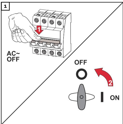
1. Sluk for ledningsrelæet.
