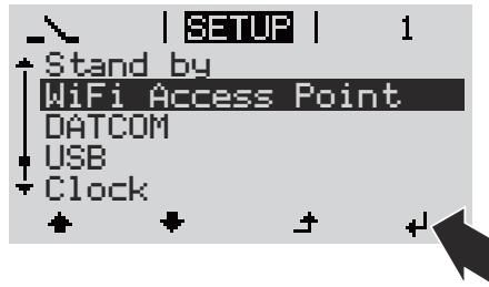
Inverteren opbygger et WLAN Access Point. WLAN Access Point forbliver åben i 1 time. Kontakten IP på Fronius Datamanager 2.0 kan blive på kontaktposition B ved aktivering af WiFi Access Point.
