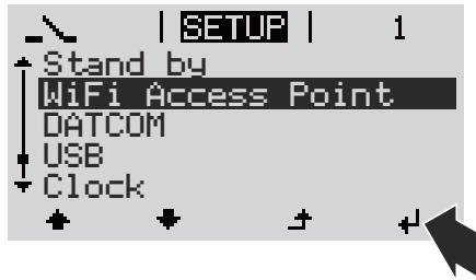
Invertteri muodostaa WLAN Access Point -käyttöpisteen. WLAN Access Point -käyttöpiste pysyy yhden tunnin avattuna. Fronius Datamanager 2.0:n IP-kytkin voi pysyä WiFi Access Point -aktivoinnin aikana asennossa B.
