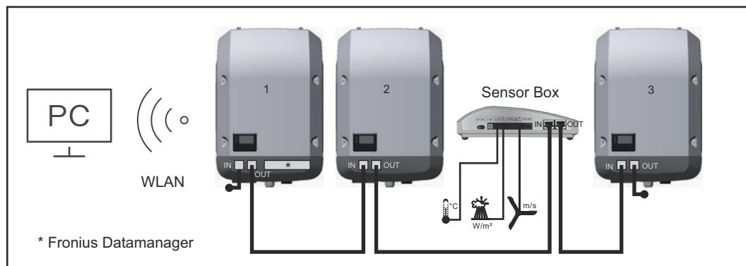
Datanätverk med 3 växelriktare och Fronius Sensor Box:
