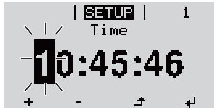
Klokkeslættet vises. (HH:MM:SS, 24-timersvisning), tier-pladsen til timen blinker.
