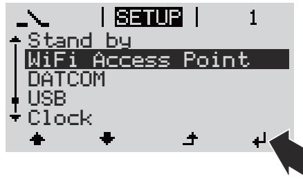
Växelriktaren skapar WLAN-accesspunkten. WLAN-accesspunkten förblir öppen i 1 timme. Brytaren IP på Fronius Datamanager 2.0 kan vara kvar i brytarläget B genom aktivering av WLAN-accesspunkten.
